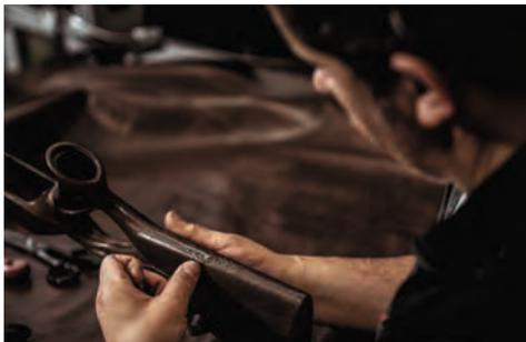
Aus aufwändig vorbearbeitetem, englischem Rindsleder werden die Überzüge für die Schäftung mit Hilfe von Schablonen manuell ausgeschnitten.
