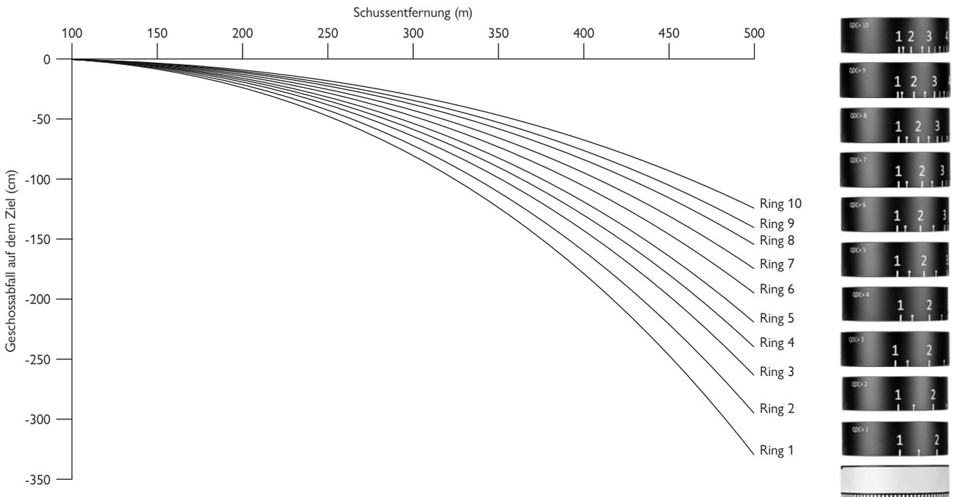
Der Ballistikrechner teilt Ihnen den passenden Ring mit und liefert eine anschauliche Darstellung der Flugbahn.
